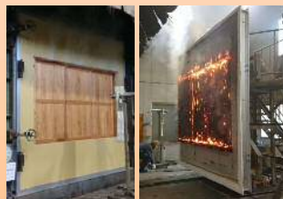
木製防火雨戸の開発に至るまでの検討、実験風景
