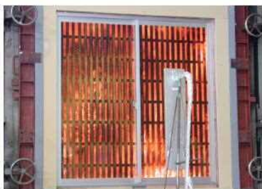
写真 加熱中の試験体の様子 * 格子の外側は燃えるが、裏側はすぐには燃えない。
